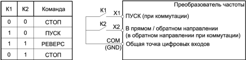
Рисунок 10.9-6. – Двухпроводная схема управления 2
