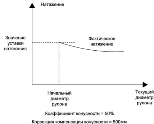
Рисунок 10.20-2. Изменение коррекции компенсации конусности
